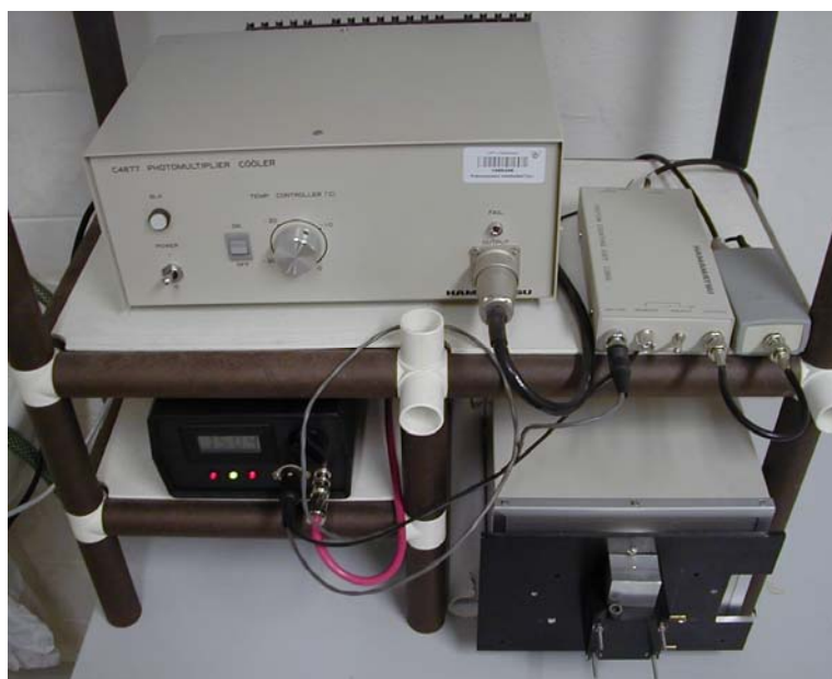
Obr. 128: Sestava pro čítání fotonů. Horní řada zleva: zdroj pro Peltiérovu chlazení, elektronika čítače fotonů, tvarovač pulsů. Dole: zdroj napájecích napětí (vysoké napětí pro fotonásobič, napájení jednotky čítače a tvarovače), jednotka fotonásobiče s měřící celou
