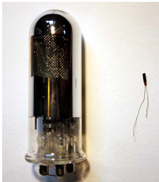
Obr. 14: Fotoelektrické detektory (vlevo: fotonka, vpravo: fototranzistor)
