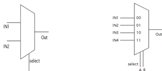
Obr. 47: Multiplexer dvou (vlevo) a čtyř vstupů (vpravo)
