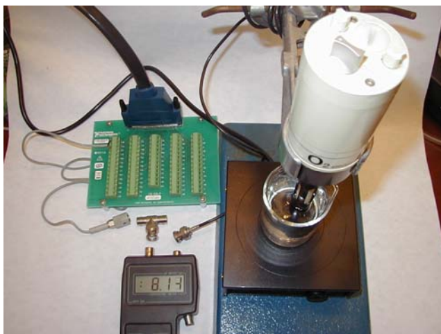
Obr. 94: Propojení kyslíkové elektrody s konektorovým blokem a kontrolním pH metrem
