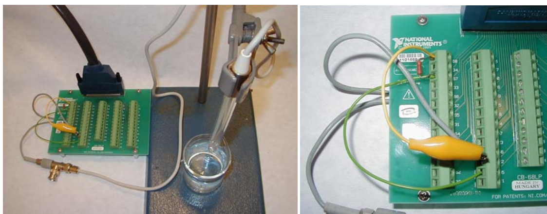
Obr. 98: Připojení konduktometrické cely ke konektorovému bloku
