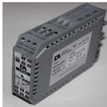
Obr. 5: Proudová smyčka 4-20 mA, schéma a ukázka vysílače
