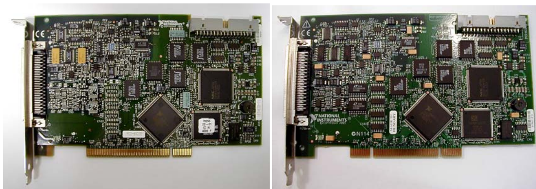
Obr. 54: Multifunkční karty série E, PCI 6023 (vlevo) a PCI 6024 (vpravo)
