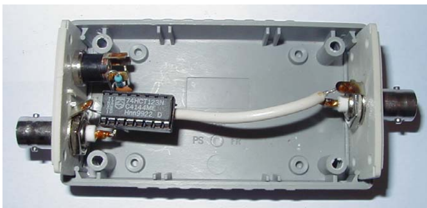
Obr. 102: Monostabilní obvod pro změnu šířky impulsů
