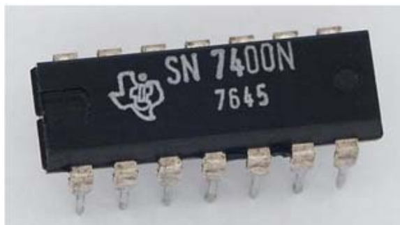
Obr. 40: Integrovaný logický obvod SN7400 a zapojení vývodů
