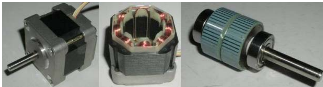
Obr. 107: Krokový motor s 200 polohami, stator a rotor
