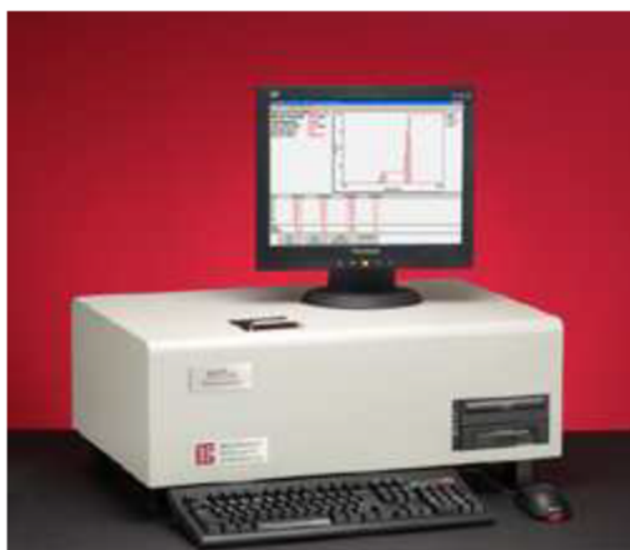
Obr. 5: Přístroj Zeta Potential Zeta Plus (90Plus), Brookhaven Instruments Corporation, USA
