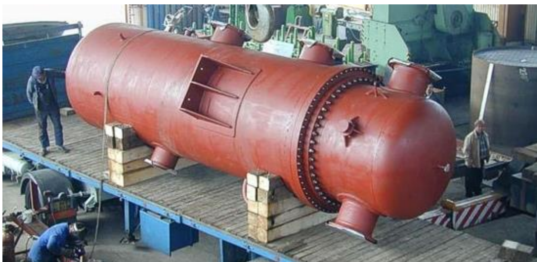
Obrázek 50. Hotový výměník (MICo, s.r.o., CZ).
