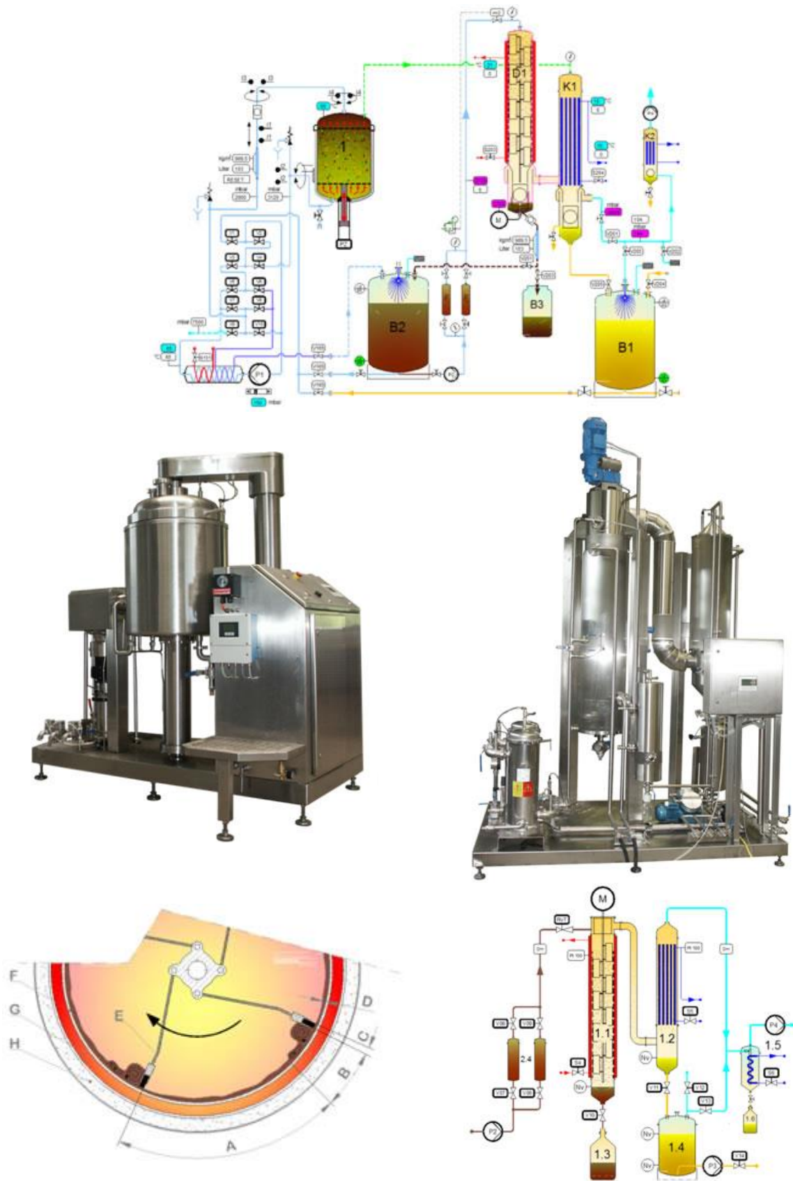
Obrázek 67. Příklad zařízení fy Samtech Extraktionstechnik GmbH, Kompletní zařízení, vsádková extrakce, regenerace rozpouštědla (převzato z www.samtech.at )
