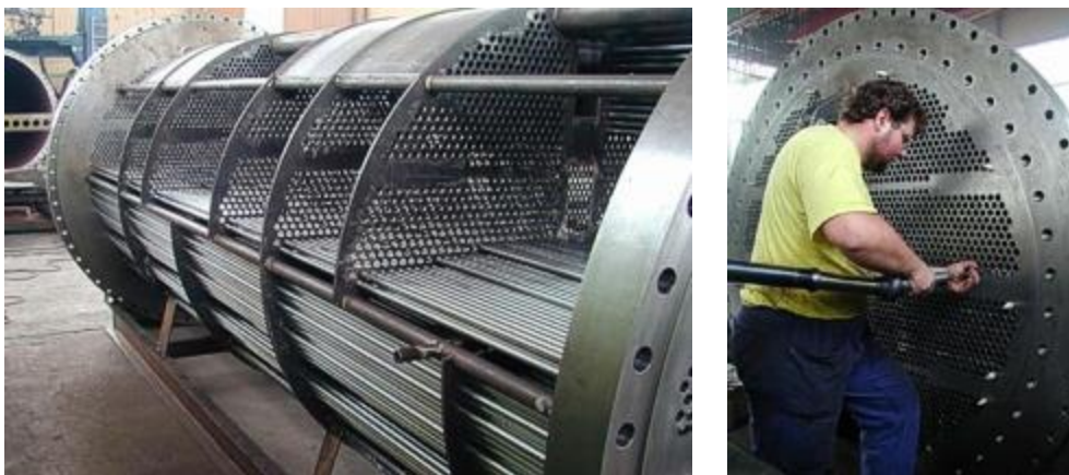
Obrázek 49. Příklad průmyslové realizace svazkového výměníku (MICo, s.r.o., CZ).
