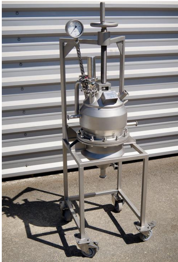
Obrázek 17. Filtr DN250, 6 bar, Hastelloy (převzato z http://www.vsk.cz/ ).
