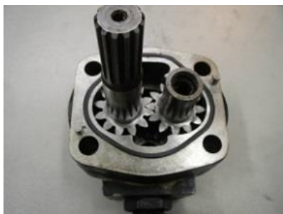
Obrázek 10. Ukázky zubovýho čerpadel (převzato z http://automatizace.hw.cz ).
