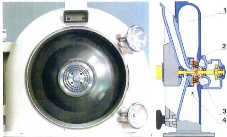
Obrázek 90. Provedení úderového mlýnu firmy ALPINE.
