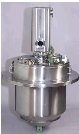
Obrázek 87. Míchaný vsádkový reaktor ve „pharma“ provedení (převzato z http://www.tectrion.de/ ).
