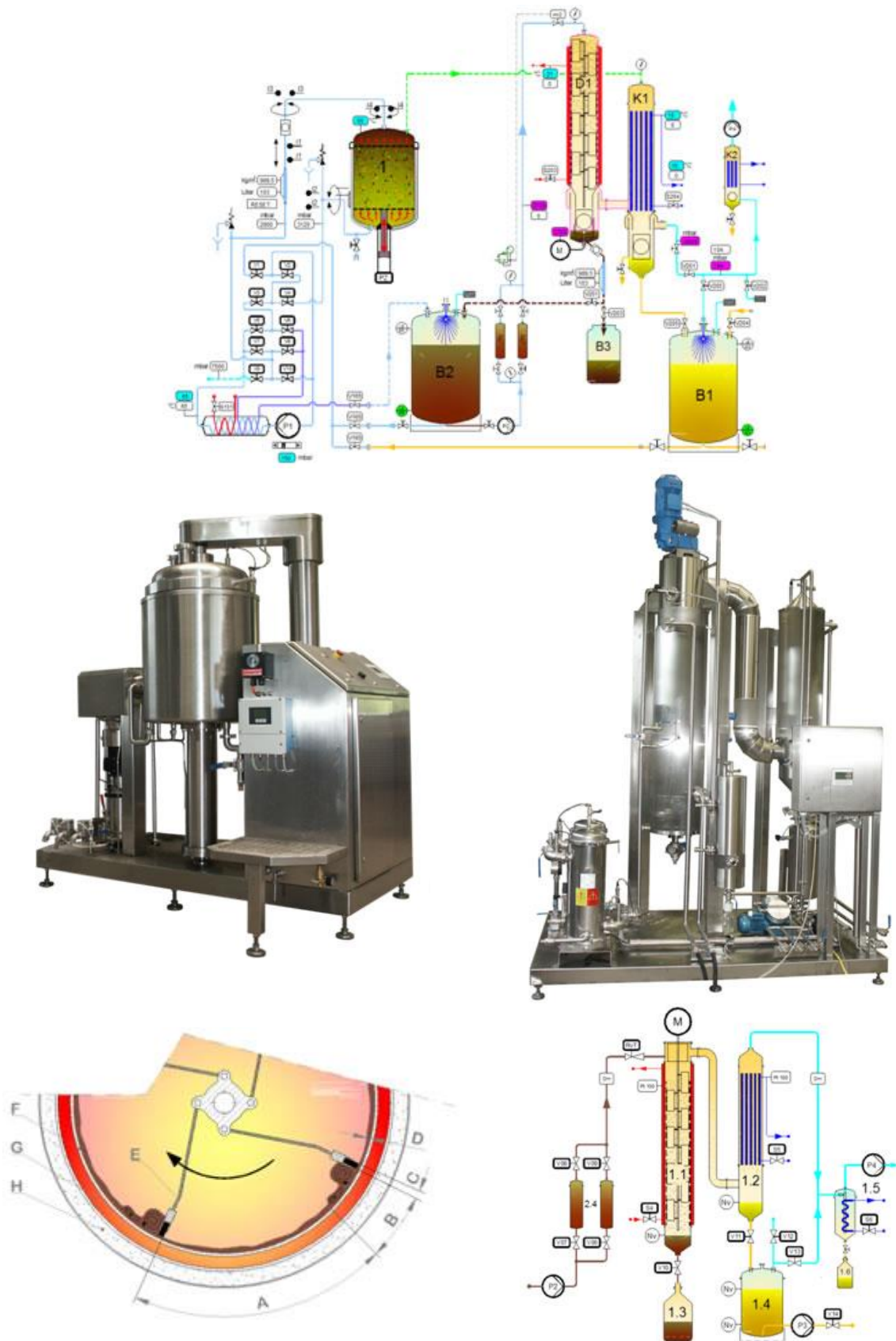
Obrázek 65. Příklad zařízení fy Samtech Extraktionstechnik GmbH, Kompletní zařízení, vsádková extrakce, regenerace rozpouštědla (převzato z www.samtech.at )
