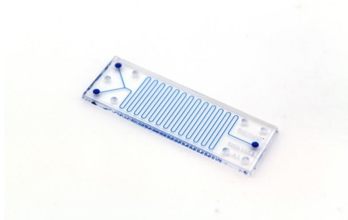
Obrázek 88. Příklad mikroreaktoru (převzato z http://store.micronit.com/ ).
