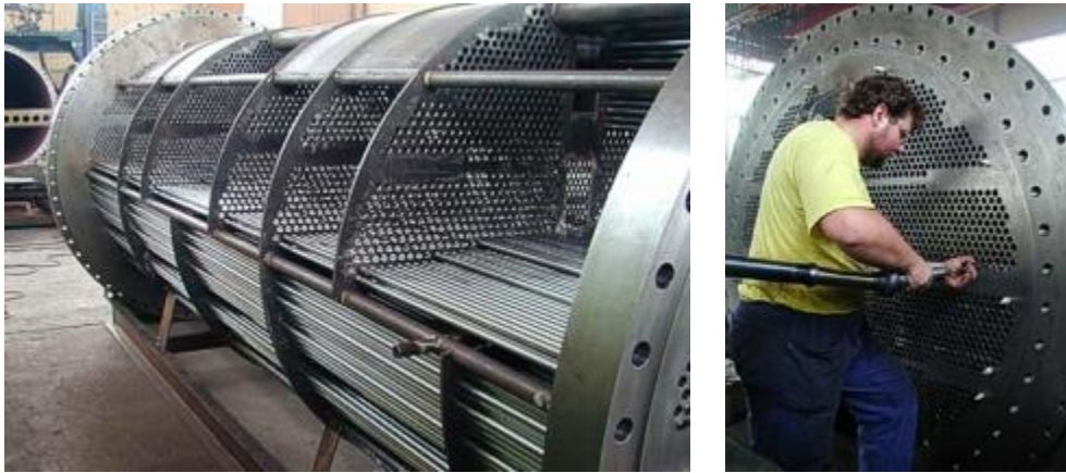
Obrázek 47. Příklad průmyslové realizace svazkového výměníku (MICo, s.r.o., CZ).
