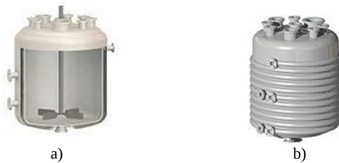
Obrázek 93. Příklady vsádkových míchaných reaktorů (převzato z http://en.wikipedia.org ).
