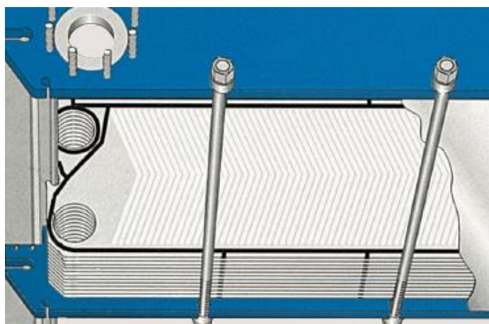
Obrázek 316. Detail desky s těsněním, Alfa Laval, SE (vlevo); komerčně dodávaný svařovaný deskový výměník, Viessmann Werke GmbH, D (vpravo).
