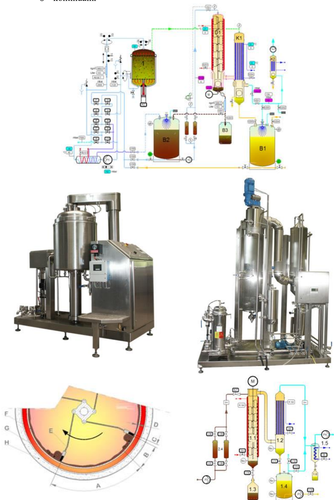
Obrázek 73. Příklad zařízení fy Samtech Extraktionstechnik GmbH, Kompletní zařízení, vsádková extrakce, regenerace rozpouštědla (převzato z www.samtech.at )
