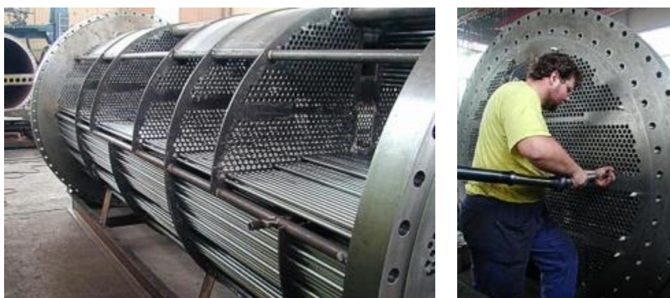
Obrázek 51. Příklad průmyslové realizace svazkového výměníku (MICO, s.r.o., CZ).
